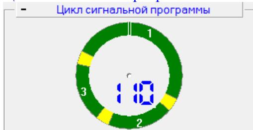
На данной диаграмме пропорционально длительности показаны фазы в порядке их следования в сигнальной программе. Диаграмма вращается против часовой стрелки, внутри отражается обратный отсчёт – время до конца/начала цикла. Текущее положение в цикле показано двумя вертикальными чёрточками вверху диаграммы.
